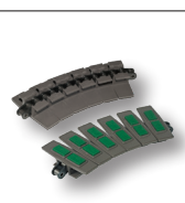
HFX 1873T 双体链 勾角型转弯 节距 3/4" (19,05 mm) 厚度 4 mm (0.157") 铰链 32,1 mm (1.264")
