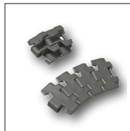
878T 勾角型转弯 增强型链片 减小转弯半径 (200 mm) 节距 1 1/2" (38,1 mm) 厚度 4,8 mm (0.189") 铰链 42,9 mm (1.689")
