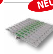
HFX 1883 Spiralkette Gummiert Kunststoffplatten Integrierte Lager Tlg. 1" (25,4 mm) Dicke 4,8 mm (0.189") Scharnier 42,9 mm (1.689")
